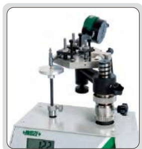
проверка измерительного усилия нутромера
