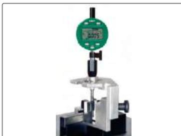
установка нуля и калибровка циферблатных
