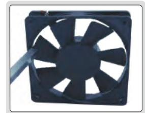
измерение зазора между лезвием и боковиной
