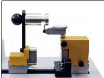
установка нуля и калибровка циферблатного компаратора
