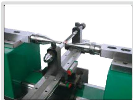
измерение резьбового кольцевого калибра
