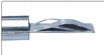
деформация зонда приводит к появлению аналогового сигнала, который затем используется программно для обеспечения расчета значения размера
