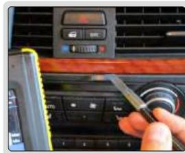
измерение зазоров на приборной панели автомобиля
