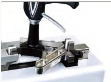
установка нуля и калибровка трехточечных внутренних микрометров
