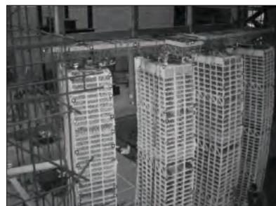
мониторинг деформации вибрационные испытания больших зданий
