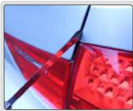
измерение швов кузова автомобиля
