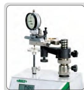
проверка силы измерения
