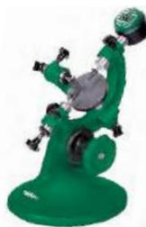
Стенды для измерения наружных диаметров
