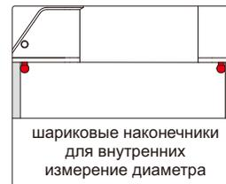
шариковые наконечники для внутренних измерение диаметра
