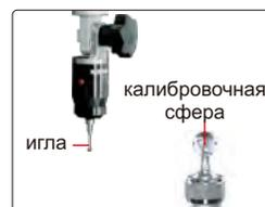
датчик (опция), включает в себя иглы  $\varnothing 2$  мм и  $\varnothing 3$  мм, калибровочная сфера  $\varnothing 25$  мм, точность измерения 10 мкм
