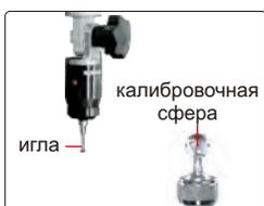
датчик (опция), включает в себя иглы  $\varnothing 2$  мм и  $\varnothing 3$  мм, калибровочную сферу  $\varnothing 25$  мм, точность измерения 10 мкм
