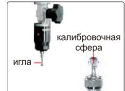
датчик (опция), включает в себя иглы Ø2 мм и Ø3 мм, калибровочную сферу Ø25 мм, точность измерения 10 мкм
