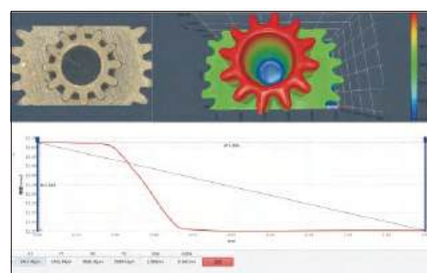
измерение высоты отверстия компонента
