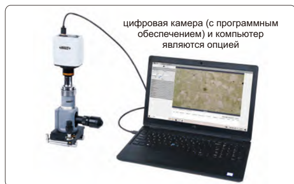
подключение к цифровой камере
