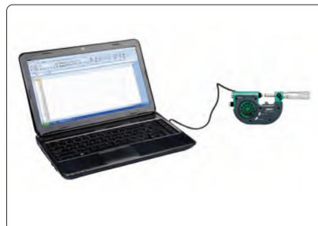
дата-выход с помощью USB-кабеля (в комплекте)
