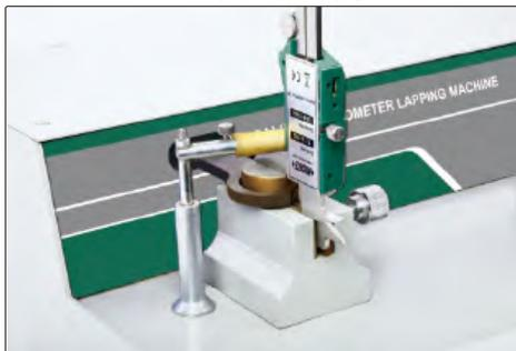
притирка измерительных поверхностей наружного микрометра
