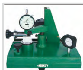
проверка воспроизводимости циферблатных индикаторов
