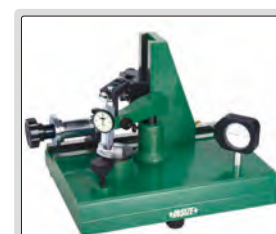
проверка влияния боковой силы на точность контрольных индикаторов (требуется полукруглый измерительный блок)
