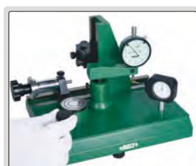
проверка усилия циферблатных индикаторов
