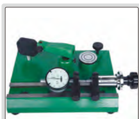
проверка точности циферблатных индикаторов (диапазон 0-25 мм)
