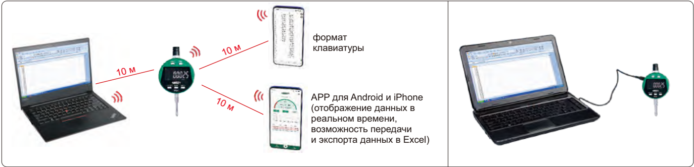
вывод данных с помощью bluetooth и USB-кабеля (в комплекте)
