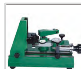
проверка точности контрольных индикаторов
