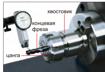
измерение радиального биения концевой фрезы
