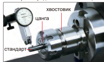
измерение радиального биения цанг
