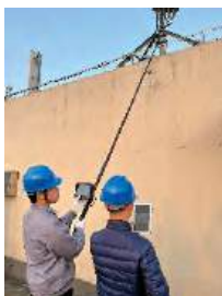
контроль конструкций (передача изображения по WI-FI в режиме реального времени)
