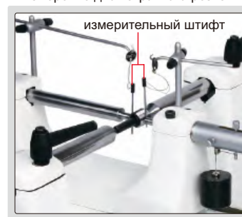
измерение диаметра шага резьбы
